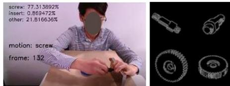
テンプレートマッチング処理と人姿勢認識を組み合わせによる組立作業の観察と自動解釈。(右図: 部品のテンプレート画像) この技術の一部を導入したロボットで、金沢大学との合同チームで World Robot Summit2018に出場し、ものづくりカテゴリー第2位を獲得。
