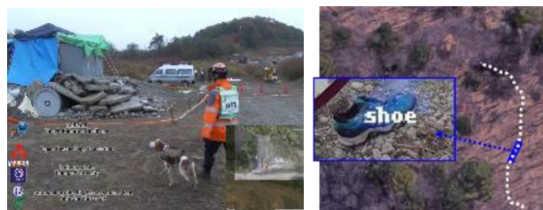
災害現場での搜索活動支援のための視覚補助システム 左図: サイバー救助犬による被災環境での搜索活動 右図: 検出された遺留品と地図上での検出位置)
