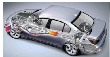
エンジン廃熱発電システム (BMW)
