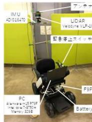
②高精度な位置姿勢は自動運転そのものだけでなく、自動運転に必要な地図情報を構築する際にも活用がされています。現在はこのようなシステムは非常に高価であります。開発した技術の応用により、地図作成のコストが低下することが期待されています。
