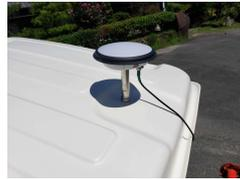
農業機器での試験例。自動車と異なり、振動が大きくなるため、特にIMUへの外乱が大きい場合の対応が重要となる
